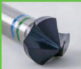
Detalonare prin rectificare variabilă
