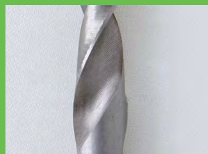
Evacuare optimă a așchiilor
